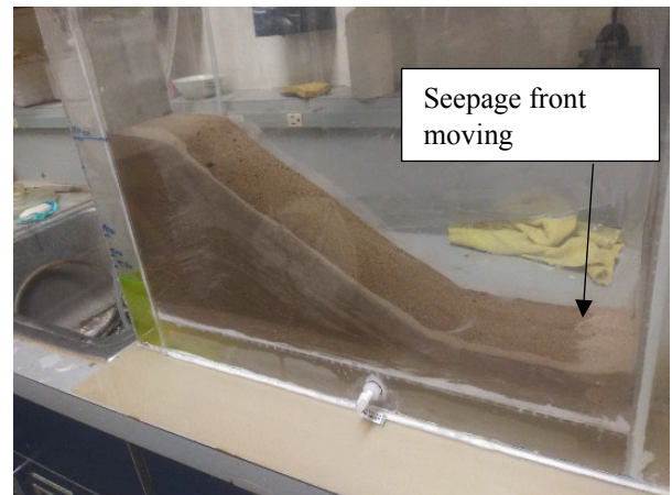
(d) Seepage front at 40 minutes
